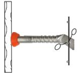
3 Nach Erreichen der notwendigen Betondruckfestigkeit die Schalung entfernen. Dabei wird der Haltekonus aus der einbetonierten Hülse gezogen. Der Doppelkopfnagel kann leicht ausgezogen und samt Konus wieder verwendet werden.
