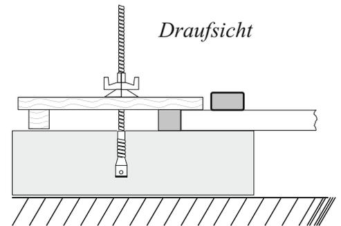
Element-Anschluß bei einhäufiger Wandschalung, Schalungshülse je nach Betonierhöhe 2 - 3 mal eingebaut.
