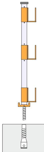
Montage von Geländerhaltern in Betonoberflächen mit der Schalungshülse Alu DW 15 "kurz"
