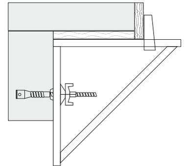
Befestigung von Zwingen, Konsolen und dergl. für Schalung von Überzügen, Unterzügen, Kragplatten, Kniestöcken, Aufkantungen, usw.
