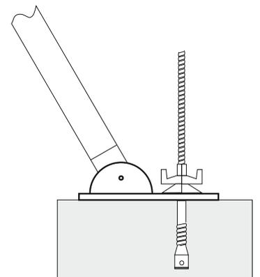
Befestigung von Richtstützen mit der "Schalungshülse lang"
